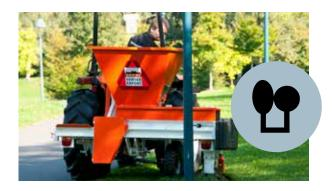
City Planter: plante les bulbes à fleurs sur une largeur de 50 cm. Le soc de plantation de cette machine se trouve sur le flanc de la machine. Elle convient pour les endroits où vous souhaitez planter d'arbre en arbre, de poteau en poteau, de banc en banc.
