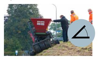
**Talus Planter:** cette machine peut planter sur une pente avec un angle maximum de 30 à 35 degrés. Elle est équipée de chenilles et d'un soc de plantation supplémentaire pour un aspect uniforme.
