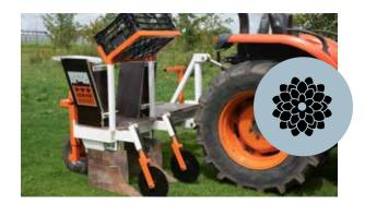
**Dahlia Planter:** une City Planter double où les tubercules sont jetés manuellement dans la trémie et plantés en deux rangs. Il n'y a pas de rouleau compresseur ou autre engin d'égalisation accroché derrière la machine étant donné que le sol doit rester meuble. Ne peut pas être utilisé sous le gazon car le sol doit tout d'abord être fraisé.
